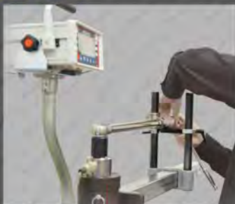
専用の校正機器を使用したトルクテスト
