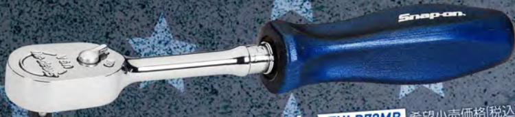
1/2" Drive Flex & Hard Grip SHLFD80AMB 希望小売価格(税込) ¥33,516 1/2インチドライブ フレックス&ハードグリップ 振り角5°(72ギア) 最大推奨トルク386N・m 全長654mm ヘッド幅41.3mm ヘッド厚19.1mm
