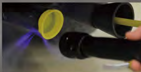
UVライトでスモークが発光し、わずかな漏れも発見が容易に
