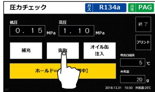
②抜取回収量を設定します
