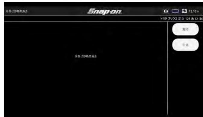
・画面左上の診断結果は、全てのシステムの故障コードが消去された場合には「全システム異常なし」、されていない場合は「○システム異常なし!」が表示されます。
